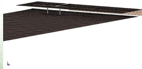
Pins connectant le plan de masse à la partie supérieure de l'antenne patch
