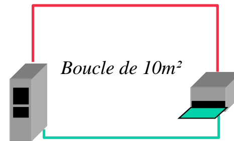
Câbles en l'air
