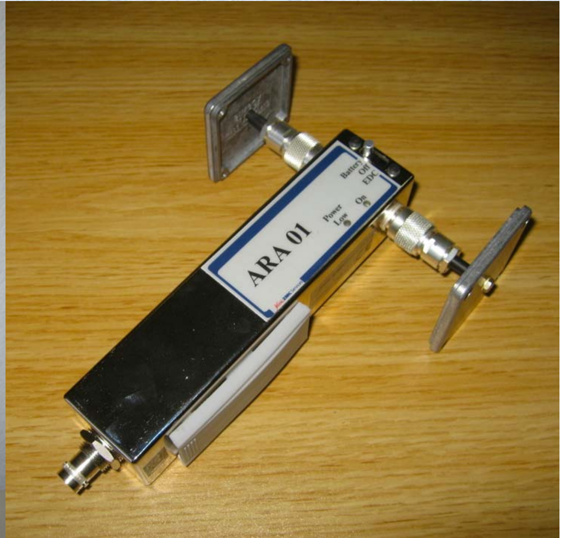
Antenne ARA01 modifiée B.P. : 200 MHz à 2,5 GHz
