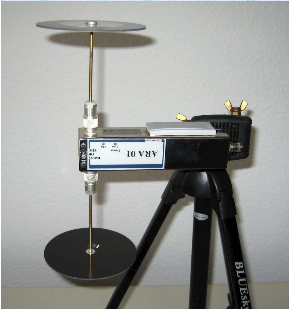
Antenne ARA01 commerciale B.P. : 100 MHz à 1 GHz
