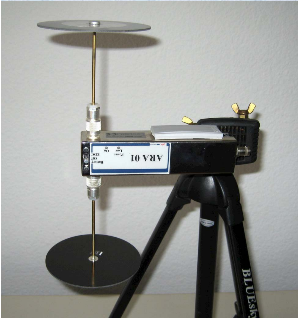
Antenne ARA01 commerciale B.P. : 100 MHz à 1 GHz
