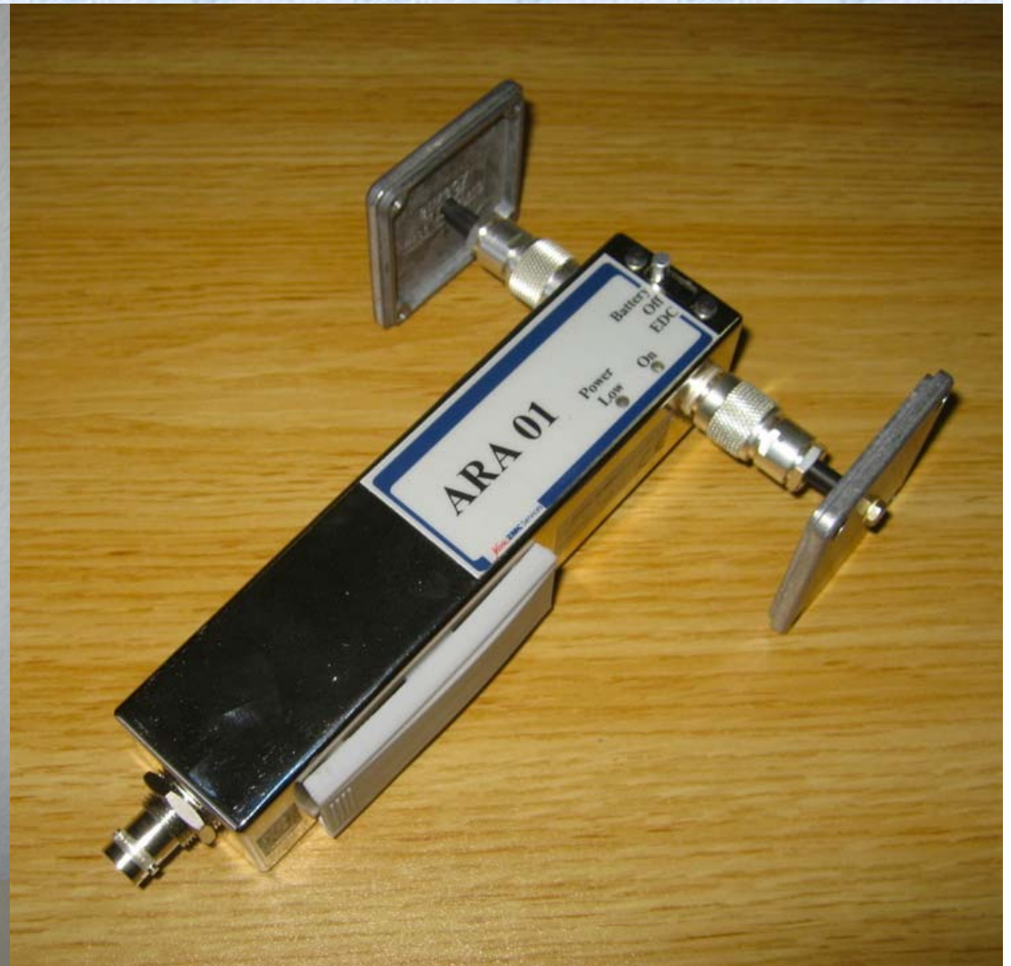
Antenne ARA01 modifiée B.P. : 200 MHz à 2,5 GHz
